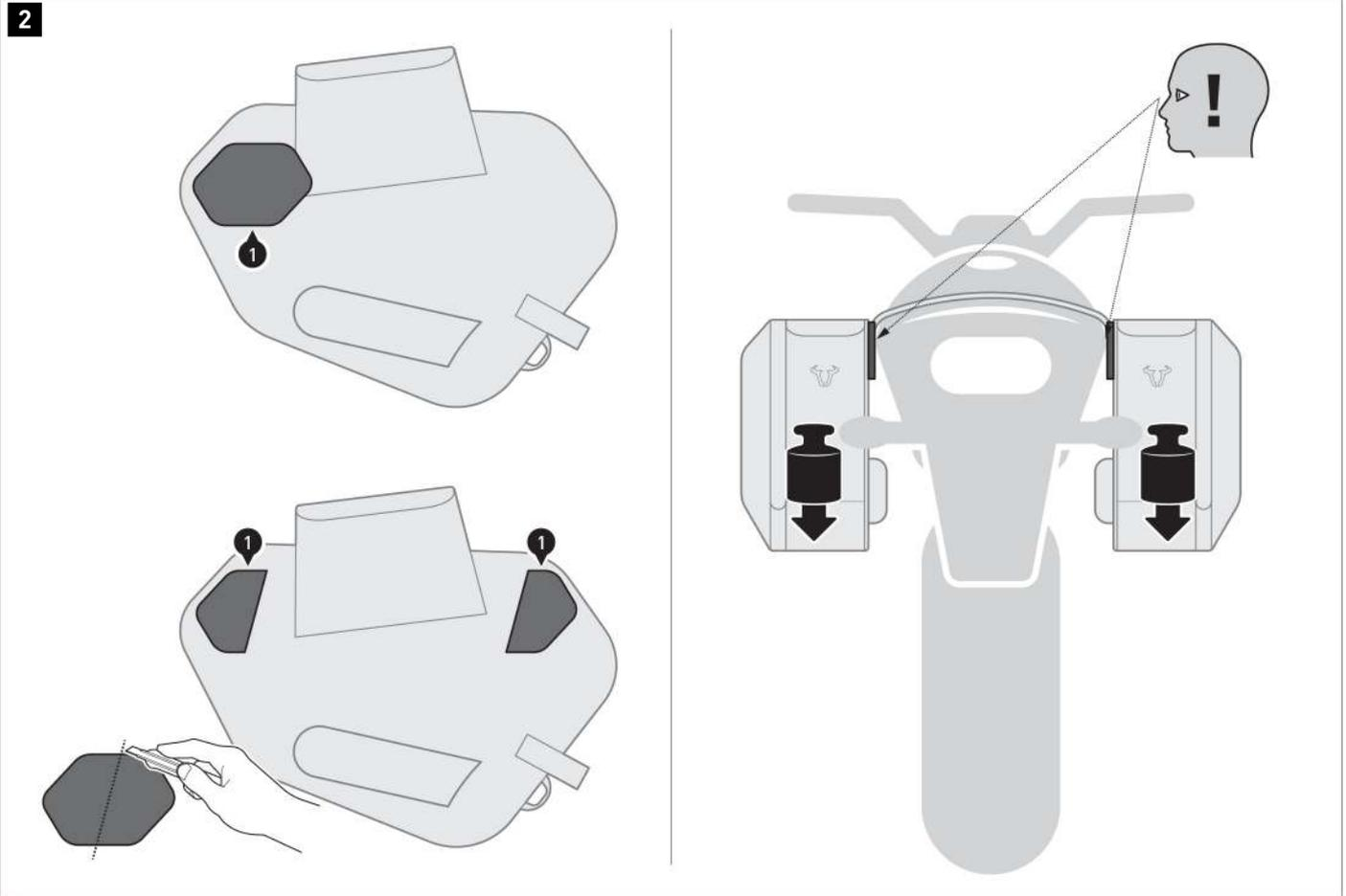
Collez maintenant les protections anti-abrasion/des arêtes (1) aux emplacements préalablement déterminés des sacs latéraux BLAZE (les positions indiquées sur les schémas sont des exemples).
