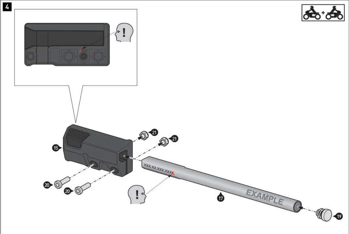
Insérer les bouchons en plastique (19) dans les extrémités des supports amovibles (17/18).
