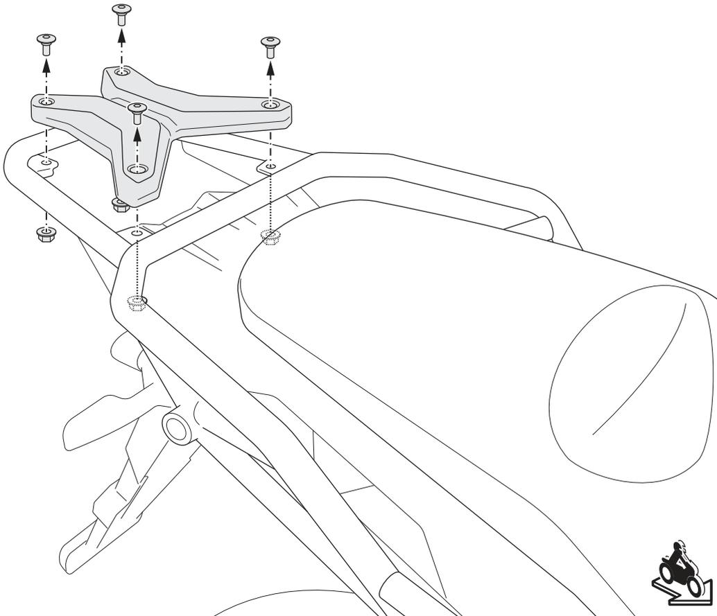
Lösen Sie die Schrauben und entfernen Sie die original Gepäckträgerabdeckung vom Fahrzeug, wie in der Zeichnung gezeigt.
