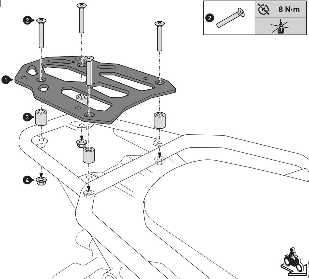
Montieren Sie das Anbaublech (1) an der Gepäckträgeraufnahme, wie in der Zeichnung gezeigt. Ziehen Sie die Schrauben wie vorgegeben an.
