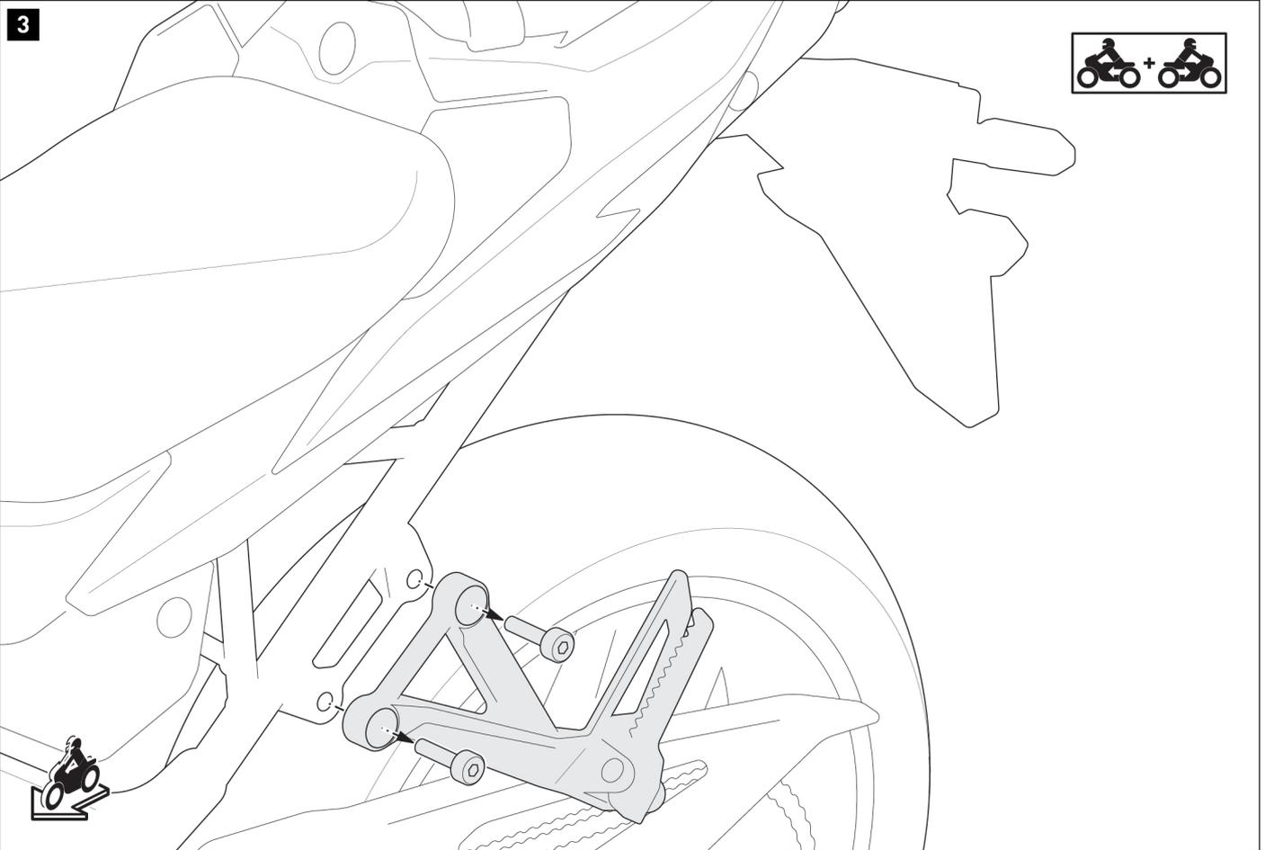
Desserrez des deux côtés les vis d'origine du support de repose-pieds passager.
