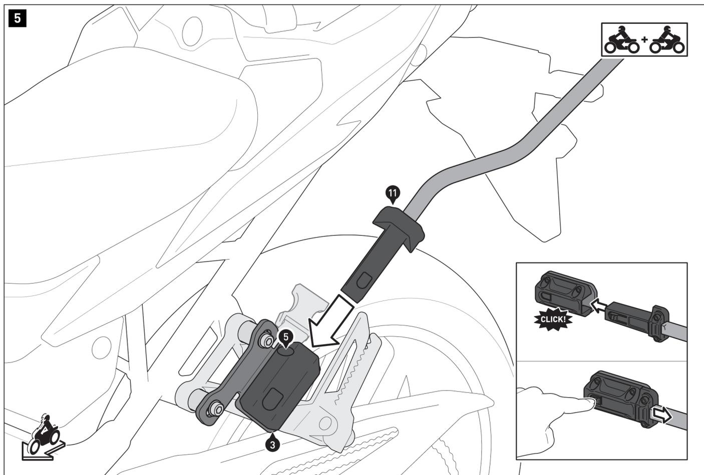
Insérez les connecteurs (11) / (12) des deux côtés dans les supports de connecteurs (3).
