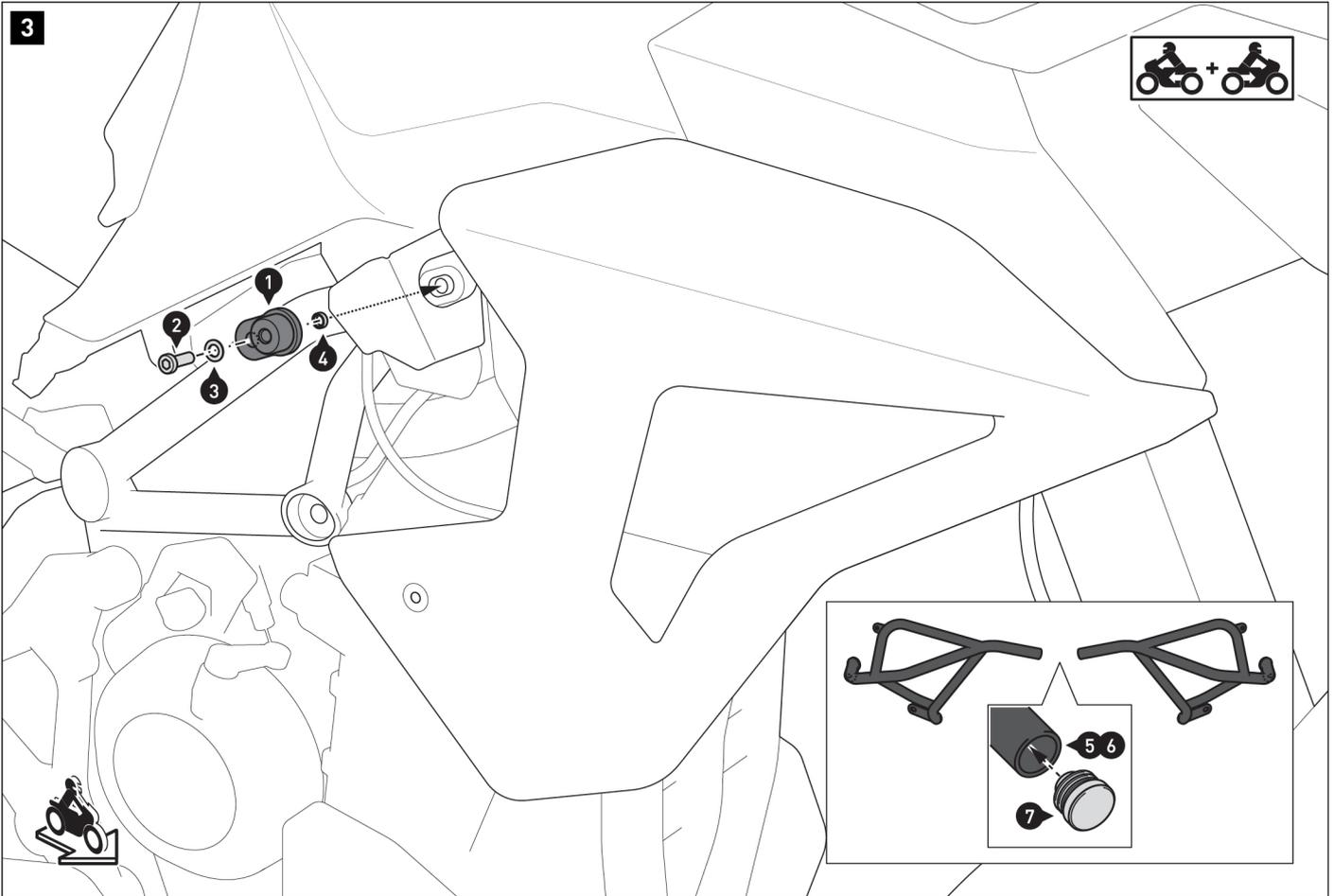
Vissez la plaque de montage (1) sous le revêtement en caoutchouc du véhicule.
