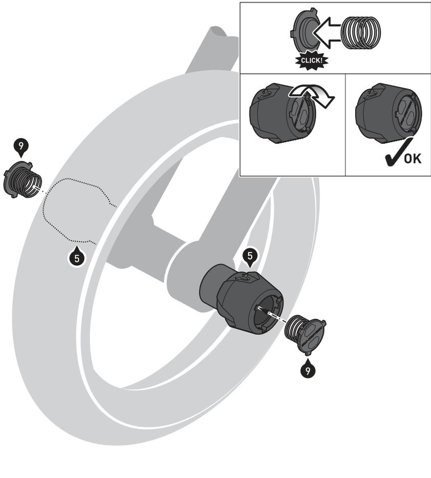
Setzen Sie **beidseitig** die Abdeckkappen (9) in die Öffnungen der montierten Sturz pads (5) ein und drehen Sie diese bis in die Endposition.
