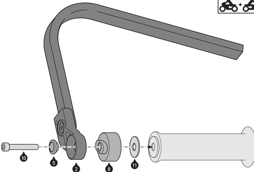
Montieren Sie die Bügelendstücke (2) an den Lenkerenden.
