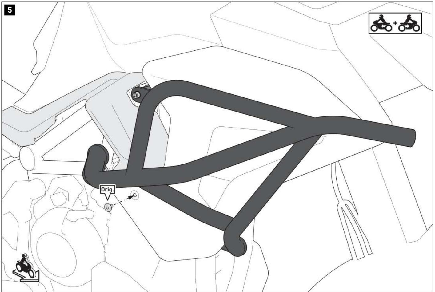
Remplacez ensuite les carénages latéraux sur le véhicule.
