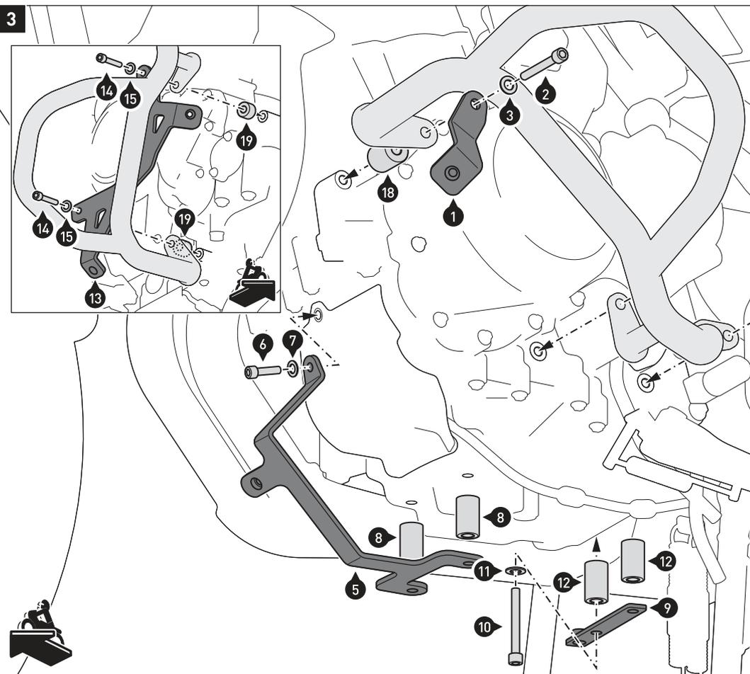
**Montage MIT original oder SW-MOTECH Sturzbügel.**
