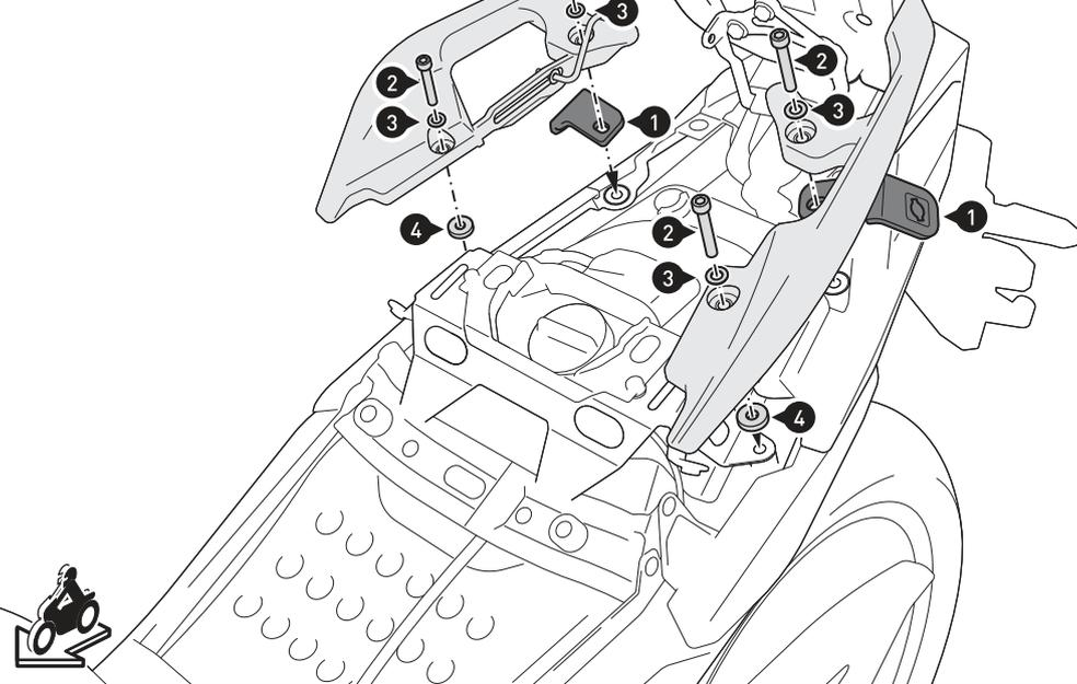
Verschrauben Sie die Befestigungslaschen (1) mit den Sozius-Haltegriffen am Fahrzeug, wie in der Zeichnung gezeigt. Halten Sie die Distanzbuchsen (4) mit etwas Fett in Position.
