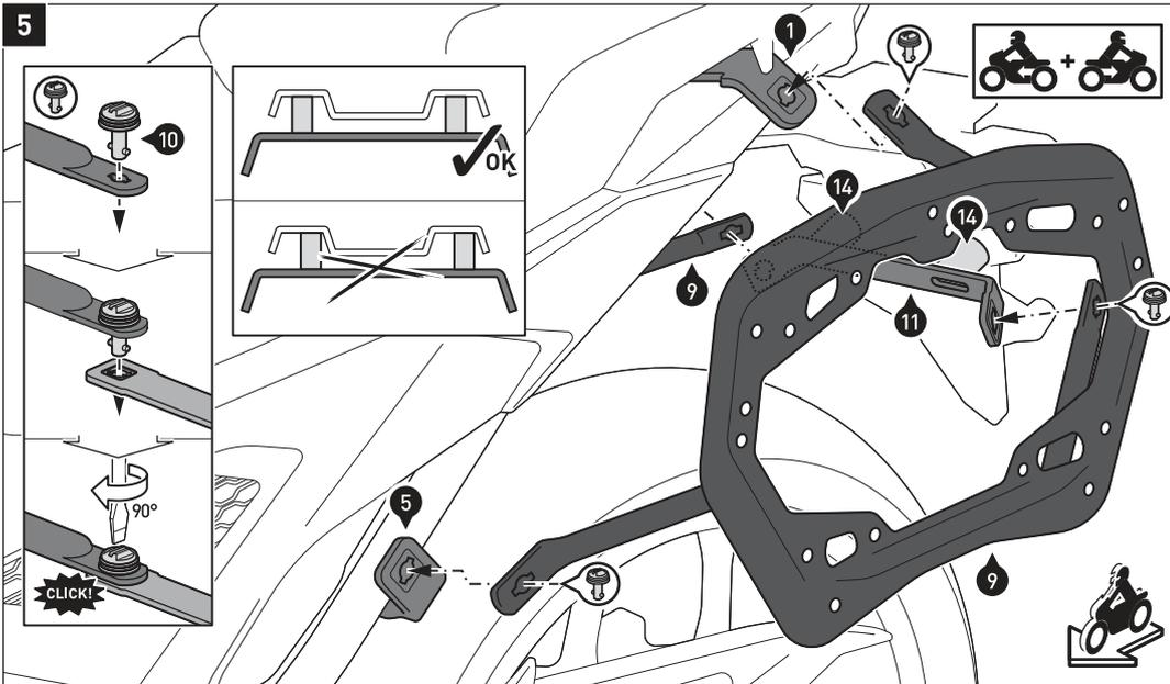
Verbinden Sie die beiden Koffertträger (9) mit den Befestigungslaschen (1) und (5); verwenden Sie die Schnellverschlüsse (10), wie in der Detailzeichnung gezeigt.
