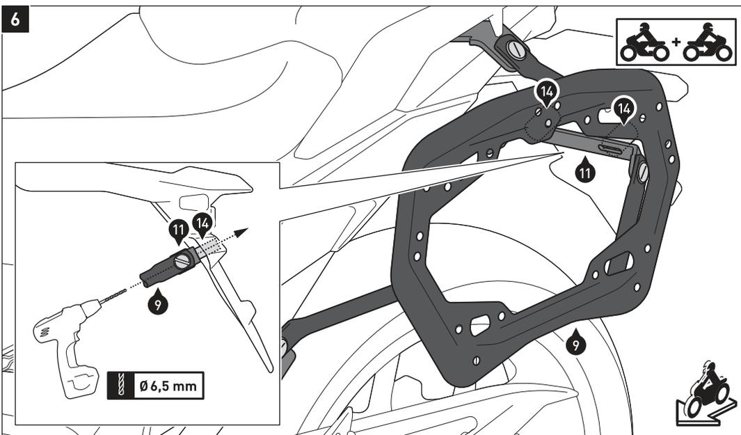
**HINWEIS:** Führen Sie die Schritte [6] und [7] nur durch, falls die Montagebohrungen des Kotflügels nicht mit dem Lochbild des Querverbinders (11) übereinstimmen.
