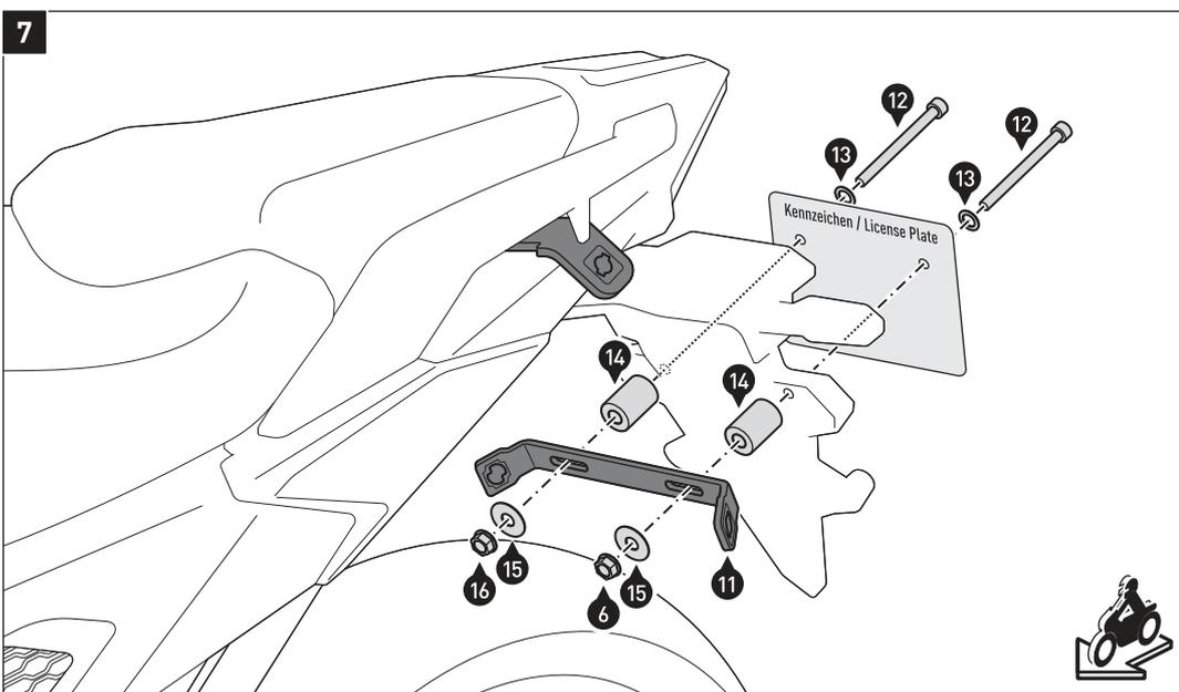
Verschrauben Sie den Querverbinder (14) am Kotflügel, wie in der Zeichnung gezeigt. Ziehen Sie die Schrauben noch nicht an.
