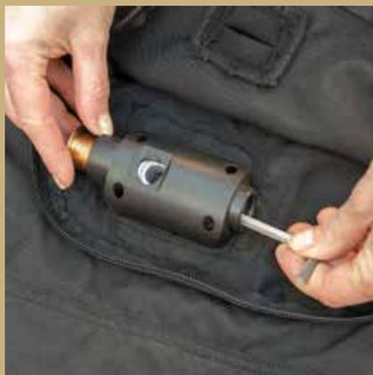
❹ Remettez le piston en place à l'aide de la clef Allen en superposant l'encoche du piston au trou du percuteur.
