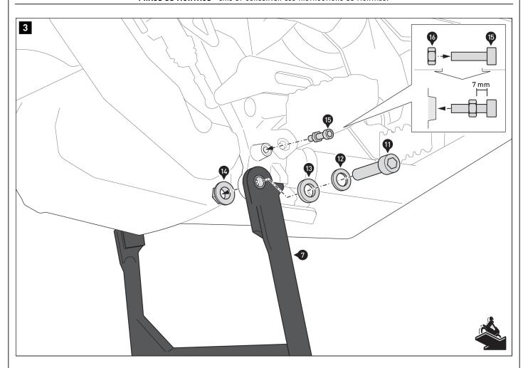
Vissez la béquille centrale (7) sur le côté droit du véhicule. Serrez maintenant les vis (8) et (11) selon les instructions du fabricant.
