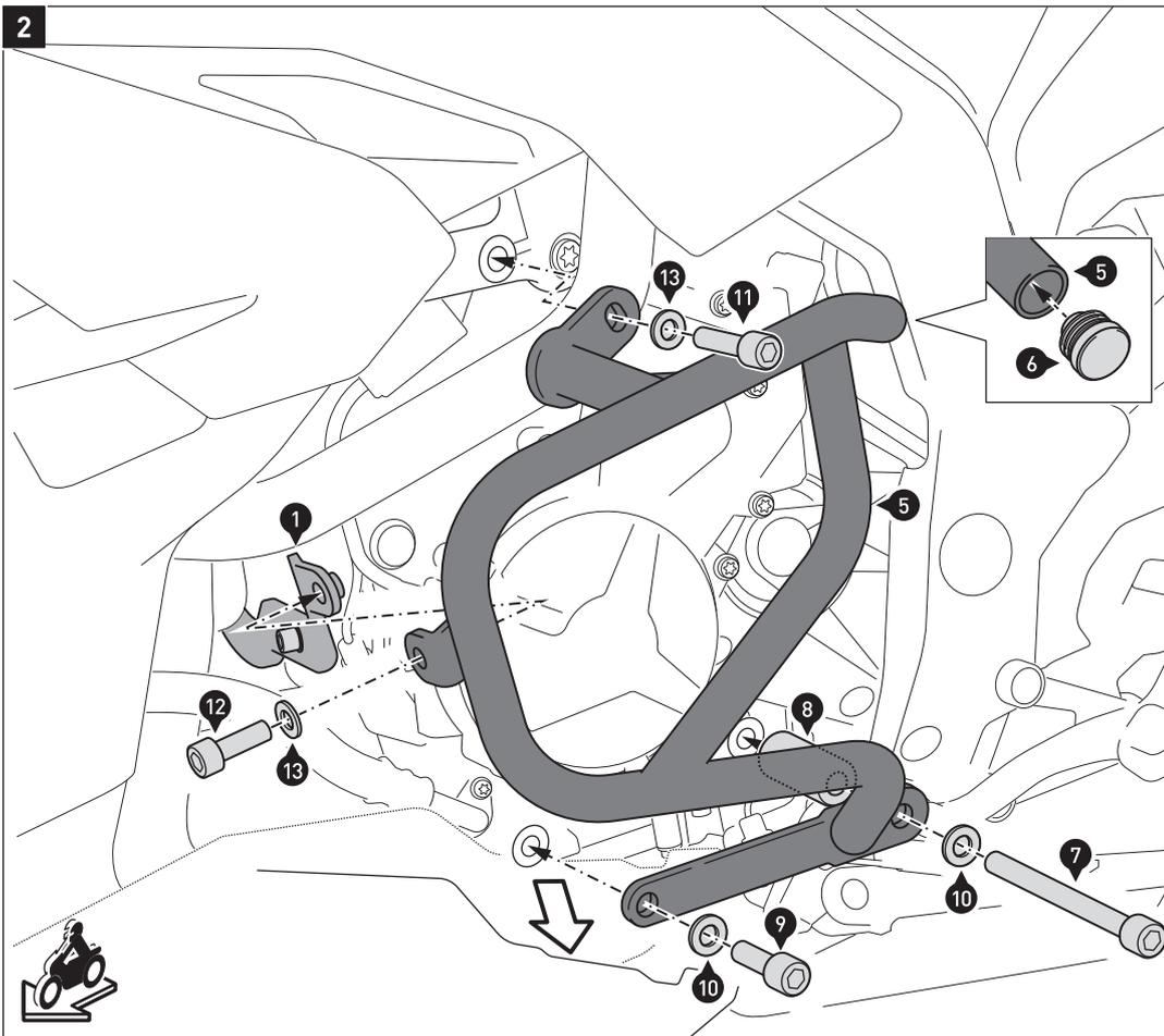
Setzen Sie den Kunststoffendstopfen (6) in den Sturzbügel (5) ein.
