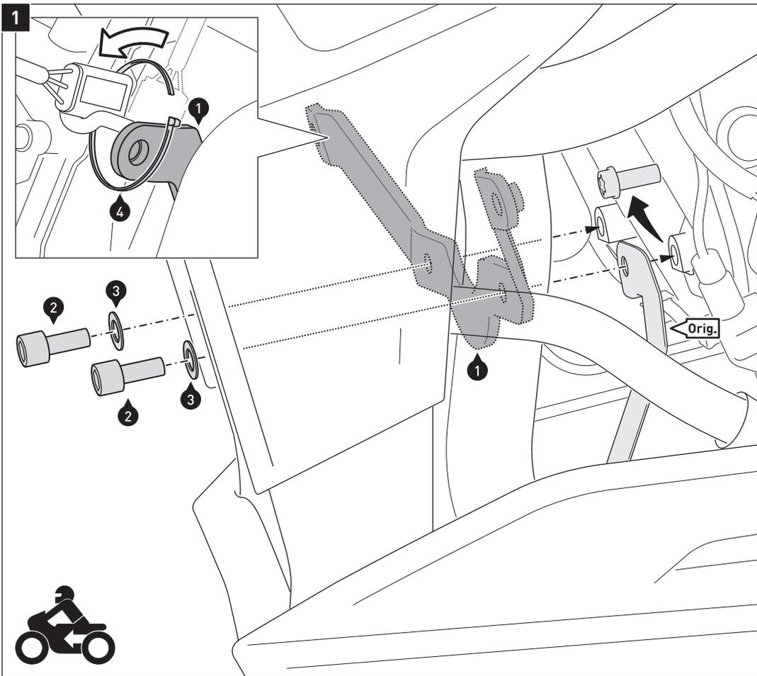
Entfernen Sie die gezeigte original Schraube auf der linken Fahrzeugseite.
