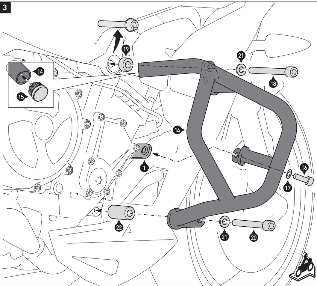
Setzen Sie die Kunststoffendstopfen (15) in den Sturzbügel (14) ein.
